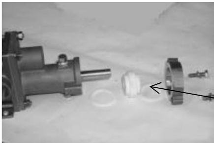
Siège de joint à joint torique et gland.
